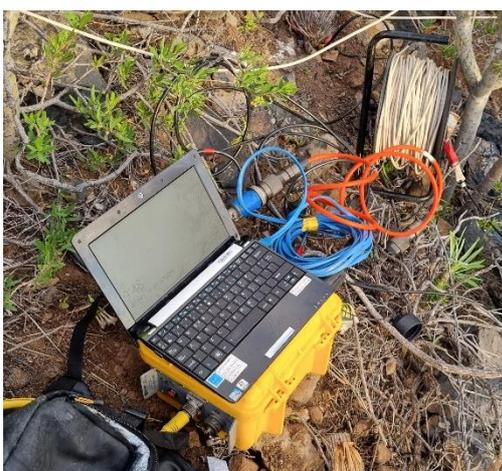
Figura 3. Sismógrafo Geode conectado a PC
