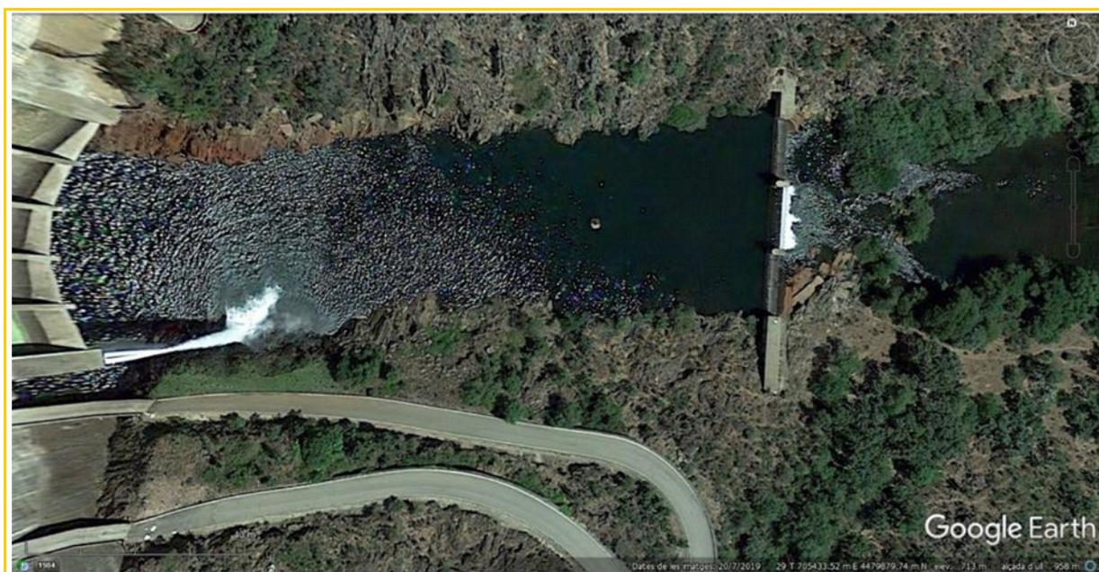
Imagen 7. Vista satelital de detalle del cuenco de amortiguación, con la presencia de afloramientos rocosos aguas abajo de la presa de Irueña, zona de las futuras actuaciones, “limpiados” por los chorros de los desagües de fondo, coloraciones más rojizas. Imagen Google Earth del 2019.
