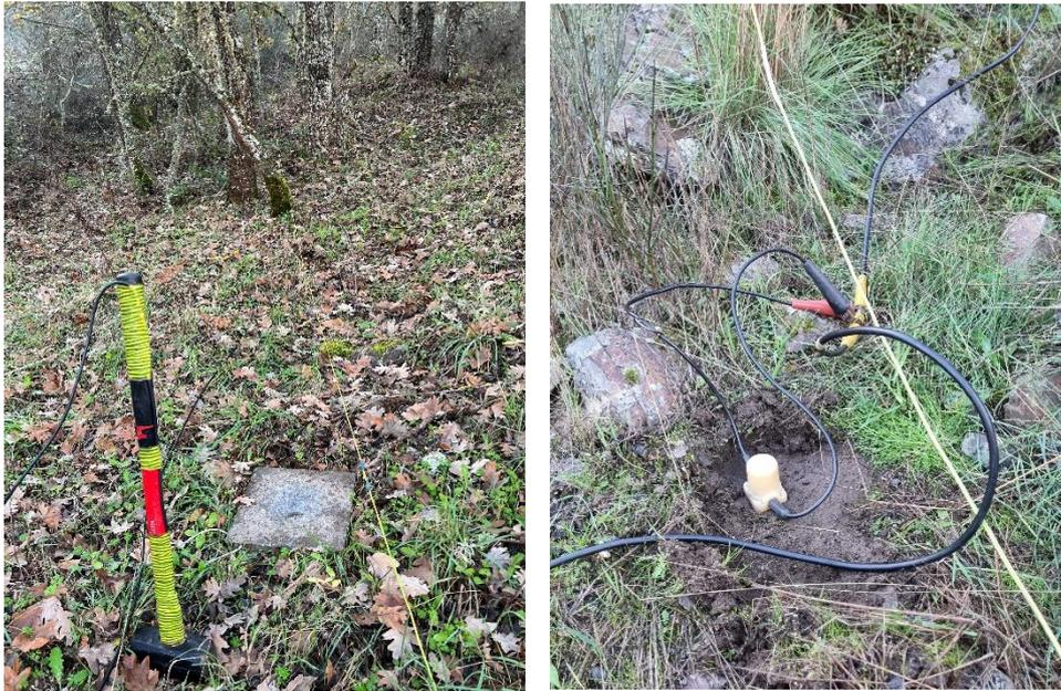
*Figura 4. Fuente de energía (izda) y geófono de 14 Hz (dcha)*
